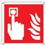
Allarme antincendio F005
