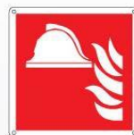
Attrezzature antincendio F004
